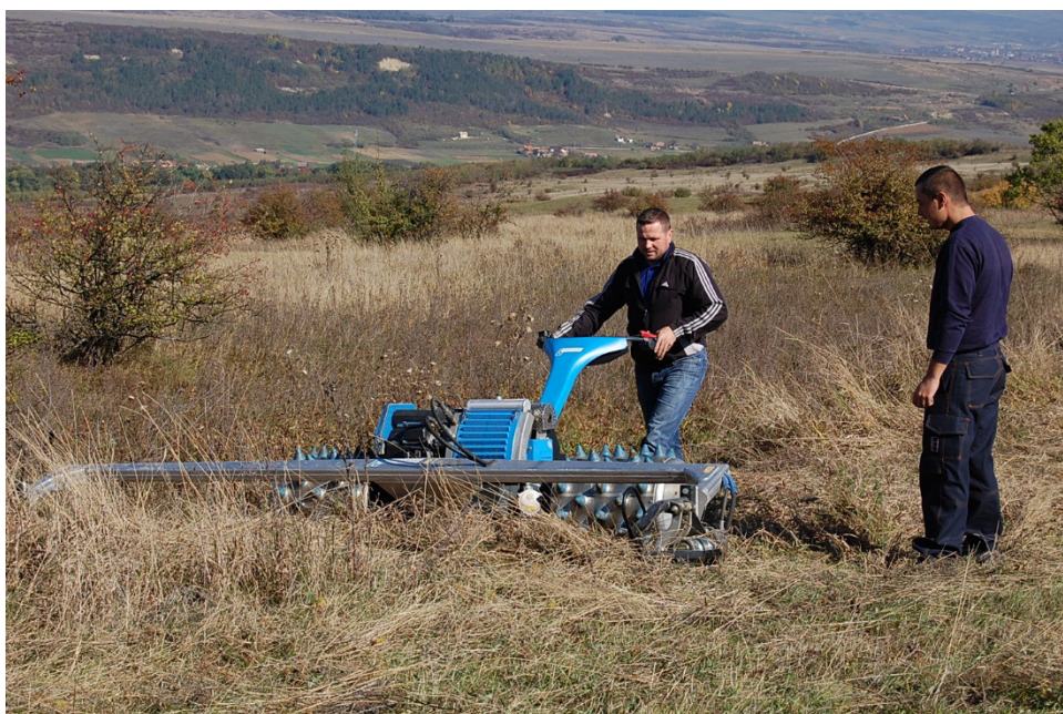
Fig 1. Motocoasă ușoară fabricată de firma Brielmaier S.R.L. utilizată la cosirea pajiștilor mezofile în zona sitului Natura 2000 Dealurile Clujului Est.
